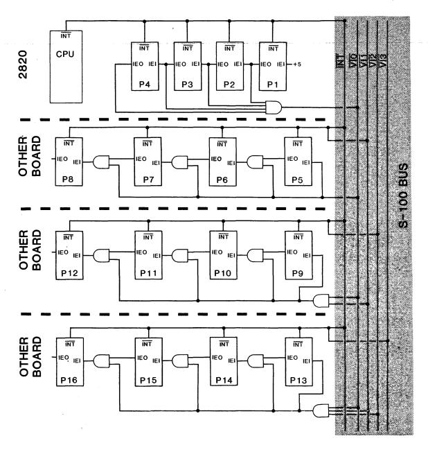
FIGURE A.1 INTERRUPT DAISY CHAIN CONFIGURATION
